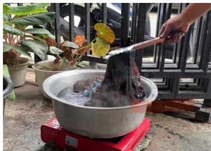
Gambar 3. Proses Melakukan Penglorodan Kain Batik
