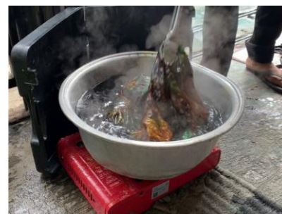
Gambar 3. Proses Melakukan Penglorodan Kain Batik
