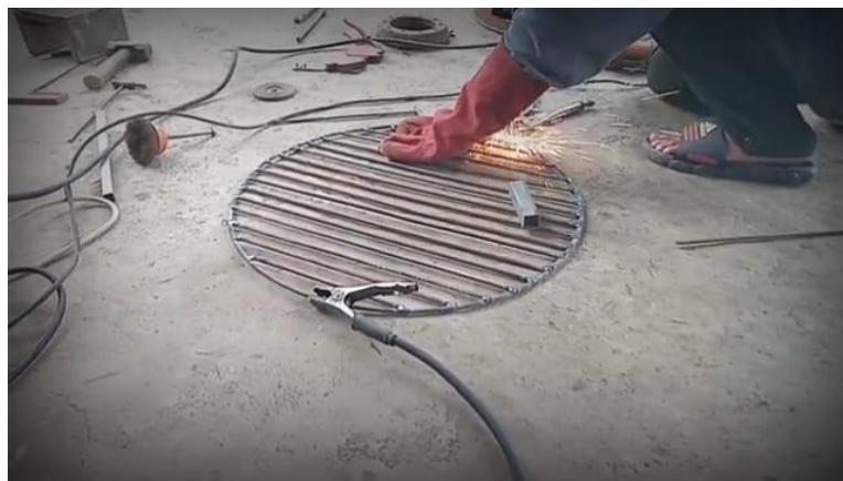
Gambar 2. Pengelasan Komponen Alat Pembakar Sampah
