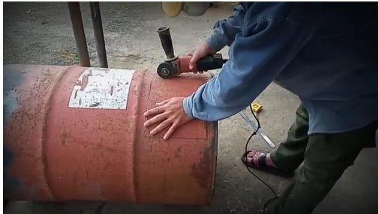
Gambar 1. Proses Pengukuran dan pemotongan drum Sampah
